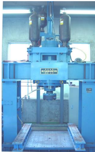
図-2.1 サーボ制御式急速载荷装置
