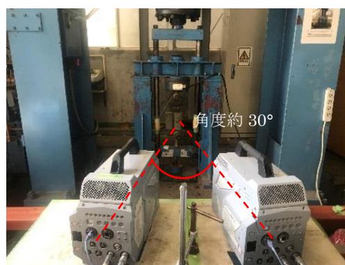
(b) 高速度ビデオカメラの撮影角度
