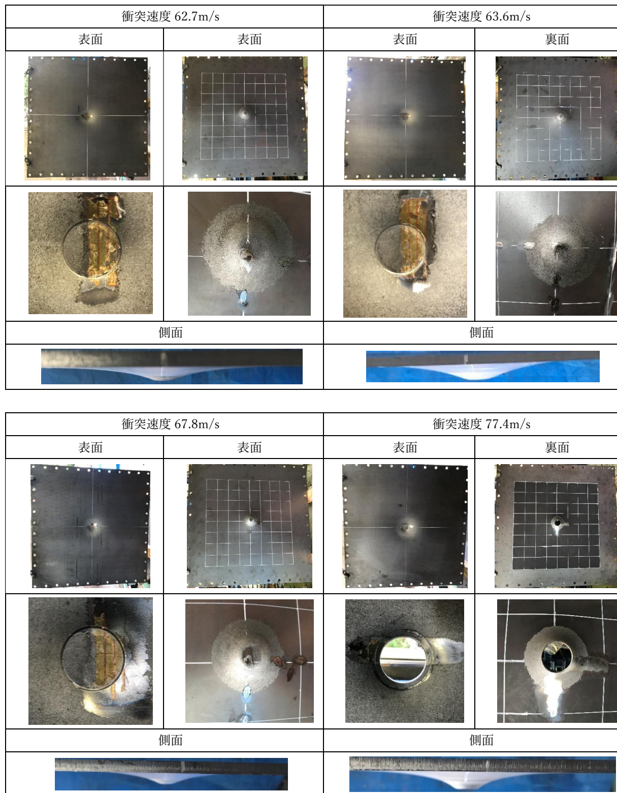
図-3.8 鋼板の破壊性状（平坦状飛翔体，板厚 9mm）
