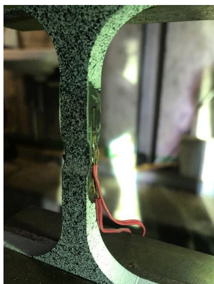
(a) 試験体のひずみゲージ貼付け箇所
