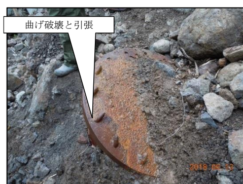
(a) ボルト部の破断
