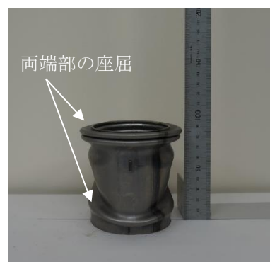
(b) 鋼管の両端に座屈が発生
