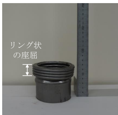
(a) 鋼管の一端に座屈が発生
