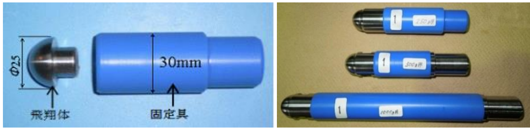
(a) 46g 飛翔体および固定具 (b) 250g, 500g および 1,000g 飛翔体
