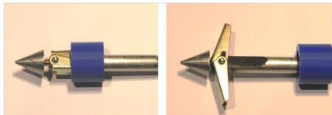
図 1.9 Duziak らによる研究の金属製銛と供試板 20)
