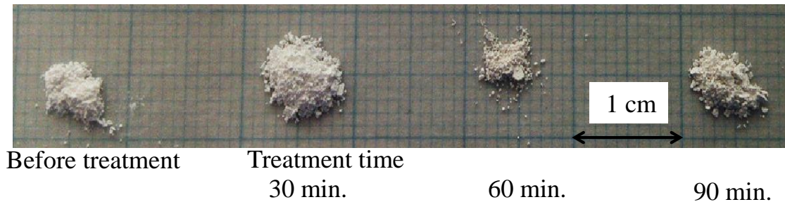
図 4.12 還元熱処理前及び、還元熱処理 400°C、処理時間 30~90 min.で還元熱処理した ZnO 粉末の光学写真
