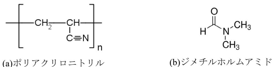
図 3.3 高分子ファイバーの材料の構造式
