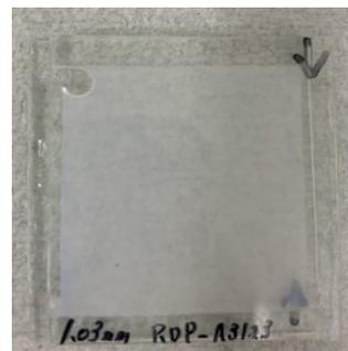
図 2.9 作製した石英ガラスセル
