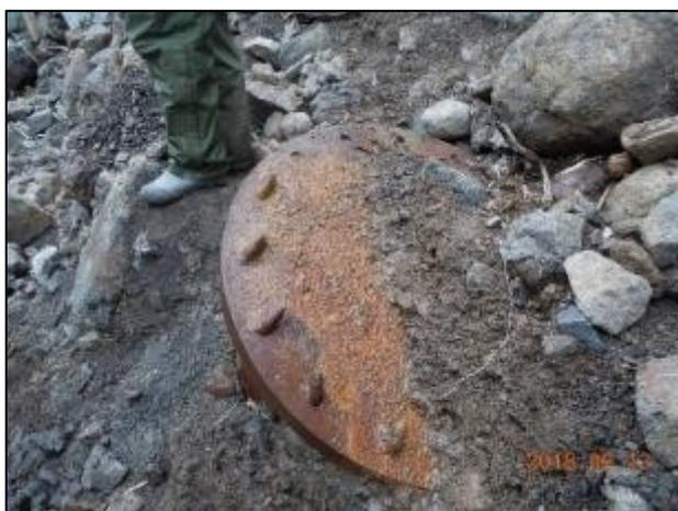
(a) 継手部の破断
