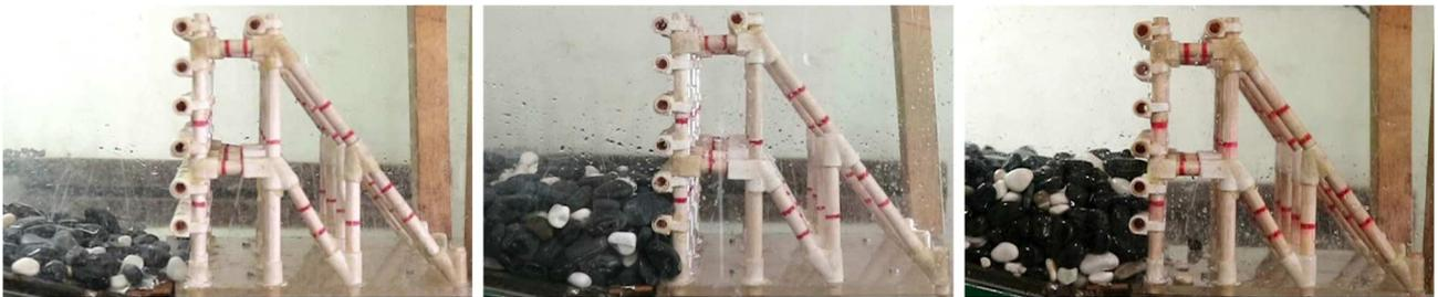
(a) 先行堆積礫高 0% (S0) (b) 先行堆積礫高 30% (S30) (c) 先行堆積礫高 50% (S50)
